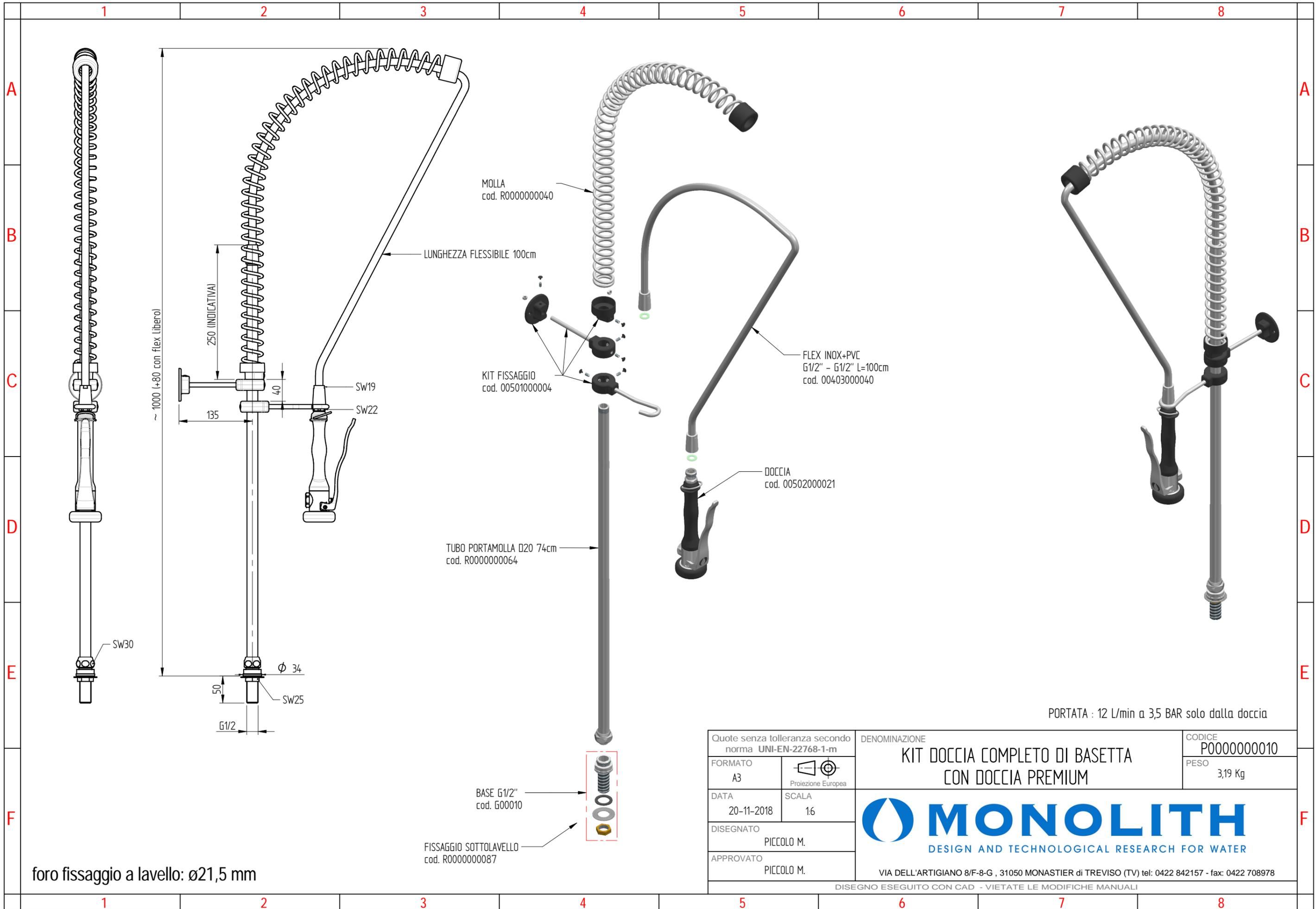
foro fissaggio a livello:  $\varnothing 21,5$  mm
